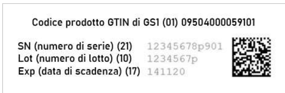
Figura 4.11. Esempio di Identificativo Univoco con le 4 informazioni (codice prodotto GTIN di GS1, numero di serie, numero del lotto e data di scadenza) codificate in un codice a barre bidimensionale GS1 Data Matrix e riportate in HRC
