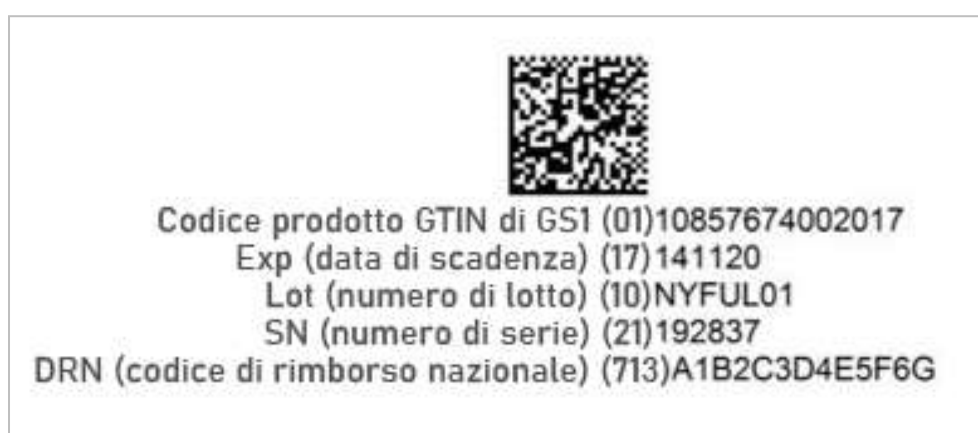
Figura 4.12. Esempio di Identificativo Univoco con 5 informazioni (codice prodotto GTIN di GS1, data di scadenza, numero del lotto, numero di serie e codice di rimborso nazionale DRN utilizzato in Brasile) codificate in un codice a barre bidimensionale GS1 Data Matrix e riportate in HRC
